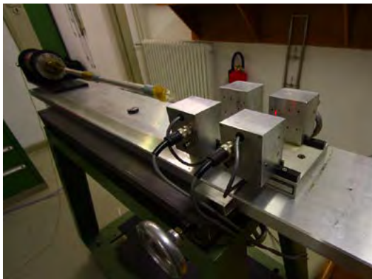
Abb. 1: Schussvorrichtung mit geschäftetem Speer im Labor für Dynamische Druckmessung der PTB (Foto: RGZM)
